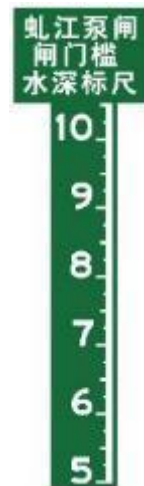
图 84 闸门槛水深标尺（代码 1002）示例
