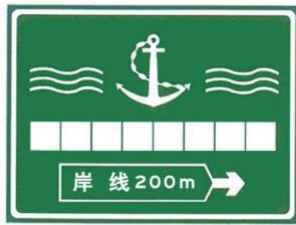
图 68 岸线使用范围标志（代码 620）示例
